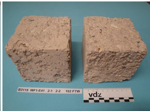
Bild 7-26 Beton WF1-E41 – CEM VI (S1-Q2), 1 FTW/Tag, Würfel 3 und 4 nach 102 FTW im Würfelverfahren
