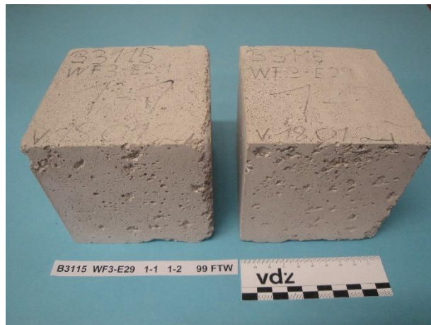
Bild 7-41 Beton WF3-E29 – CEM VI (S1-LL1), 1 FTW/Tag, Würfel 1 und 2 nach 99 FTW im Würfelverfahren
