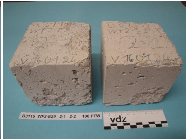
Bild 7-36 Beton WF2-E29 – CEM VI (S1-LL1), 1 FTW/Tag, Würfel 3 und 4 nach 100 FTW im Würfelverfahren
