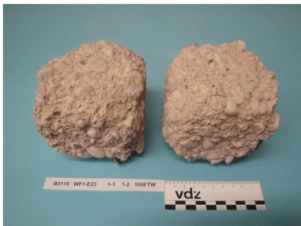
Bild 7-9 Beton WF1-E23 – CEM II/C-M (Q1-LL2), 1 FTW/Tag, Würfel 1 und 2 nach 99 FTW im Würfelverfahren
