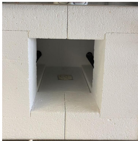
Abbildung 45: Elektrischer Hochtemperatur-Heizofen Carbolite Gero RHF 1600
