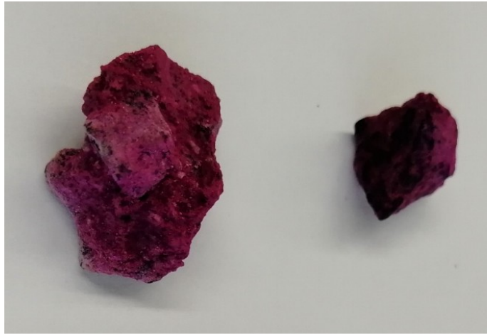
Abbildung 9: Phenolphthaleintest der frisch gebrochenen RC-Gesteinskörnung aus Brückenkappe.
