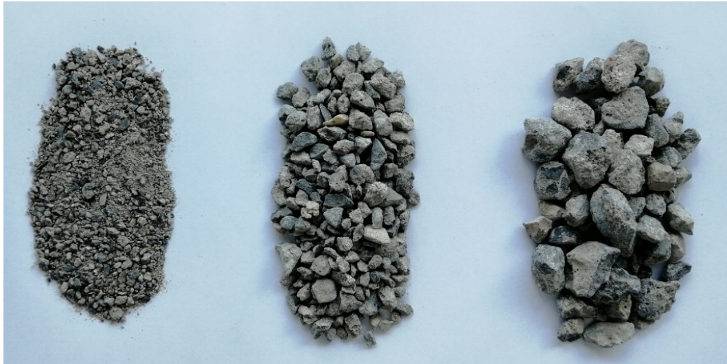
Abbildung 4: Korngruppen 0/2 (links), 2/8 (Mitte) und 8/16 (rechts).
