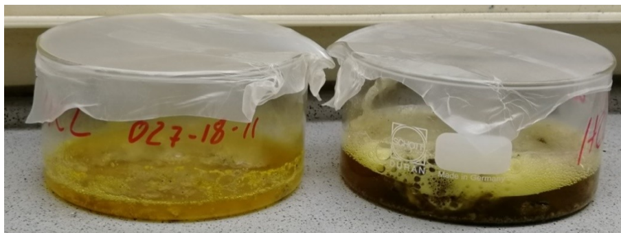
Abbildung 6: Lagerung in Salzsäure.
