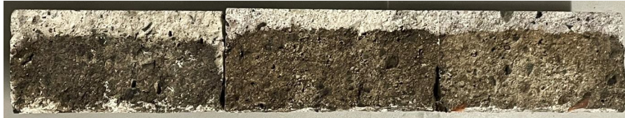
Abbildung 18: Gegenüberstellung - Chlorideindringtiefe an Probekörpern.
