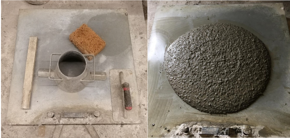
Abbildung 24: Bestimmung des Ausbreitmaßes.
