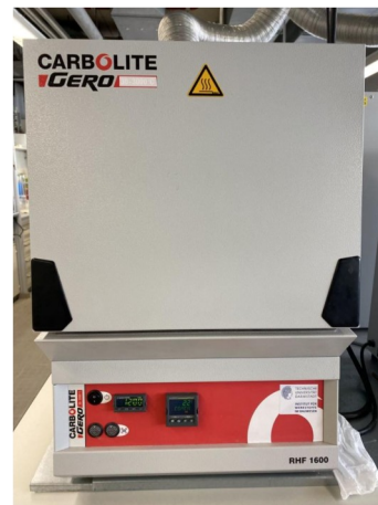
Abbildung 45: Elektrischer Hochtemperatur-Heizofen Carbolite Gero RHF 1600
