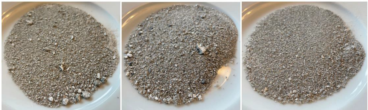
Abbildung 13: Gegenüberstellung - abgewittertes Material nach 28 Frost-Tau-Wechseln.
