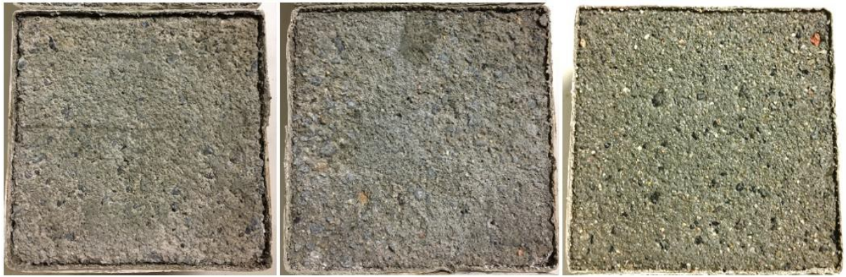
Abbildung 12: Gegenüberstellung - Prüfflächen der Probekörper für CDF-Prüfung.
