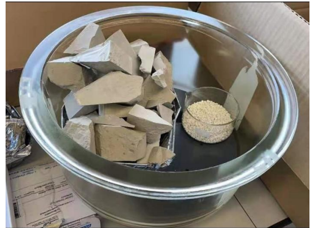
Abbildung 43: Getrocknete Betonproben, gelagert im Exsikkator
