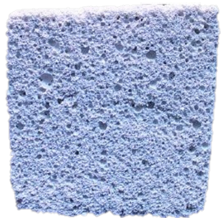
Abbildung 39: Wärmeleitfähigkeit, Rohdichte und Aufnahme des mineralisierten Schaums (R3); rechts mit Zielrohddichte von 100 kg/m 3 .
