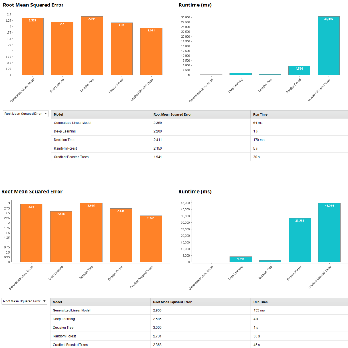
Abbildung 14 RMSE verschiedener Modelle zur Vorhersage der Festigkeit nach 28 Tagen in RapidMiner für zwei zufällig ausgewählte Werksstandorte
